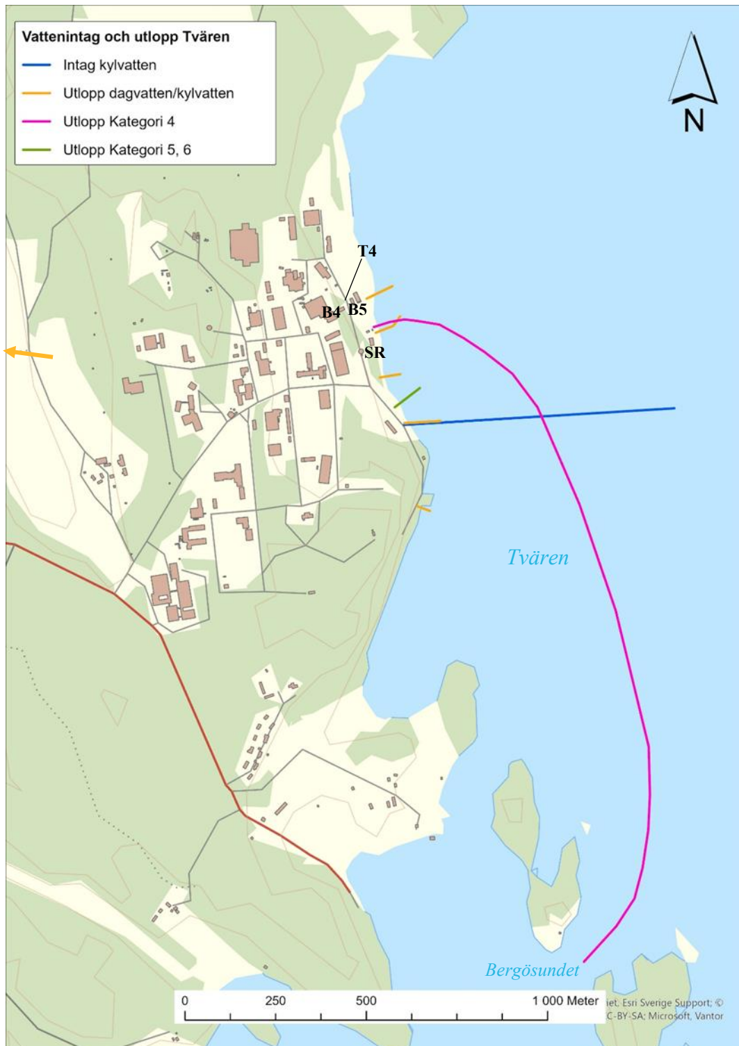
Figur 6. Kartan visar SNAB:s intagpunkt och utsläppspunkter gällande kylvatten respektive avloppsvatten, dagvatten, kylvatten och sanitärt avloppsvatten i Tvären och Bergösundet. Kategori 4 = Lågaktiv avfallsvätska, Kategori 5 = Processvatten, Kategori 6 = Sanitärt avloppsvatten. Gul pil i väster pekar ut dagvattenutloppet mot Trobbofjärden.
