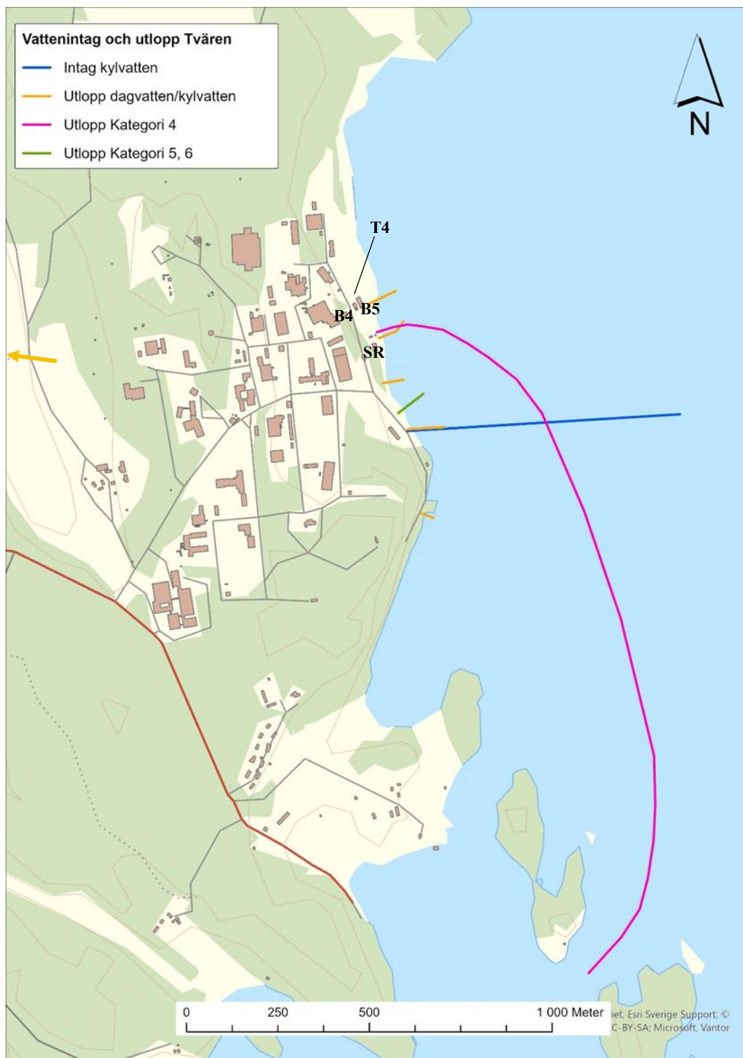
Figur 7. Kartan visar SNAB:s intagspunkt och utsläppspunkter gällande kylvatten respektive avloppsvatten, dagvatten, kylvatten och sanitärt avloppsvatten i Tvären och Bergösundet. Kategori 4 = Lågaktiv avfallsvätska, Kategori 5 = Processvatten, Kategori 6 = Sanitärt avloppsvatten. Gul pil i väster pekar ut dagvattenutloppet mot Trobbofjärden.
